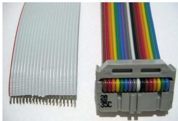
Abbildung 2-19: Flachbandkabel mit Flachbandstecker, 16-polig
