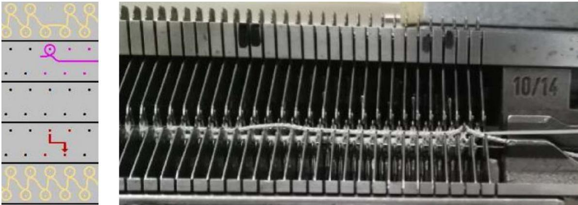
Abbildung 4-8: Befestigung des Schussfadens mit Henkel
