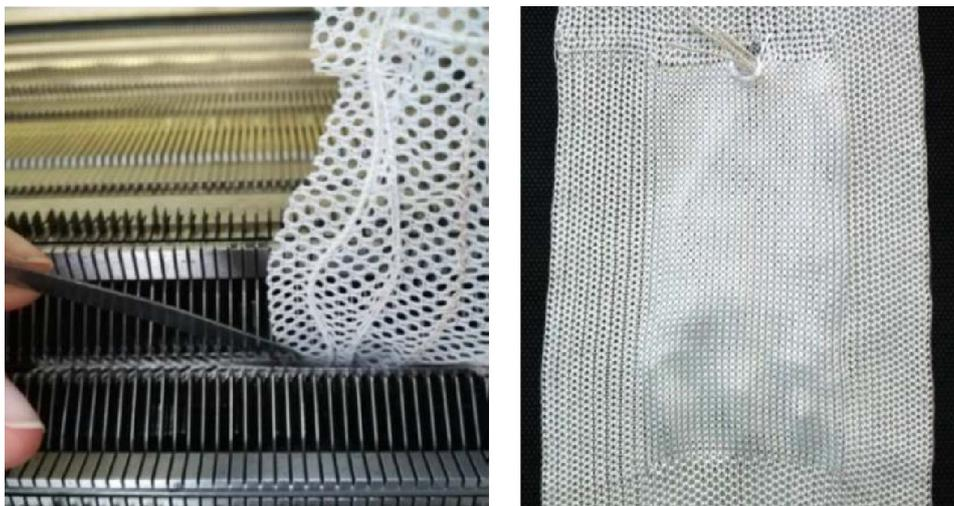
Abbildung 4-12: Einlegevorgang (links) und eingelegtes Sensornetzwerk (rechts) in der gestricktem Tasche
