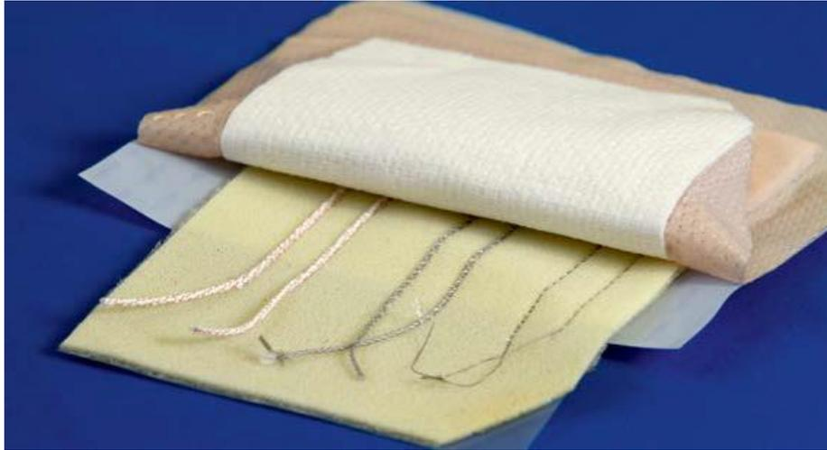
*Abbildung 6-3: Wundverband mit Schaumschicht und applizierten Feuchte-, pH-Wert- sowie Temperatursensor (v. l. n. r).*
