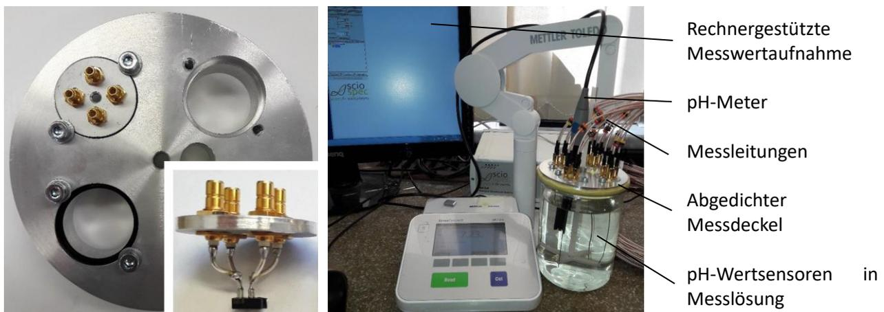
Abbildung 5-12: Messdeckel mit Einspannelementen (links) und Messaufbau für pH-Wertmessungen (rechts)
