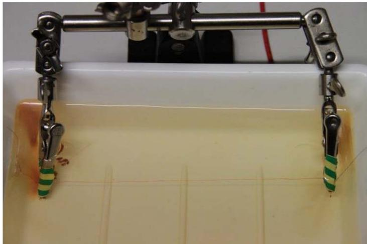
Abbildung 3-2: Degradierter Kupferlackdraht nach 3 Tagen in PBS
