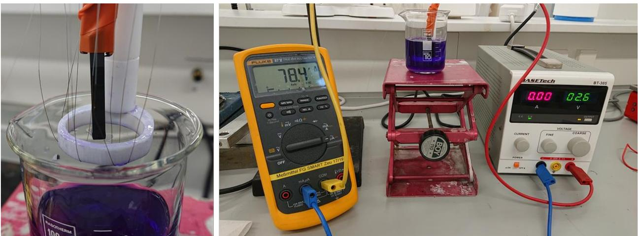
Abbildung 3-11: Stützstruktur mit umwickeltem Silberdraht und Graphitstab als Anode (links) und Versuchsaufbau zur Goldbeschichtung (rechts)
