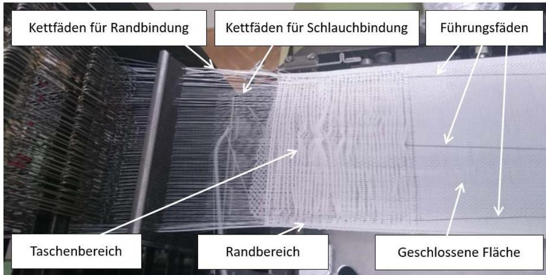
Abbildung 4-14: Draufsicht der Nadelbandwebmaschine während der Herstellung der Taschenstruktur
