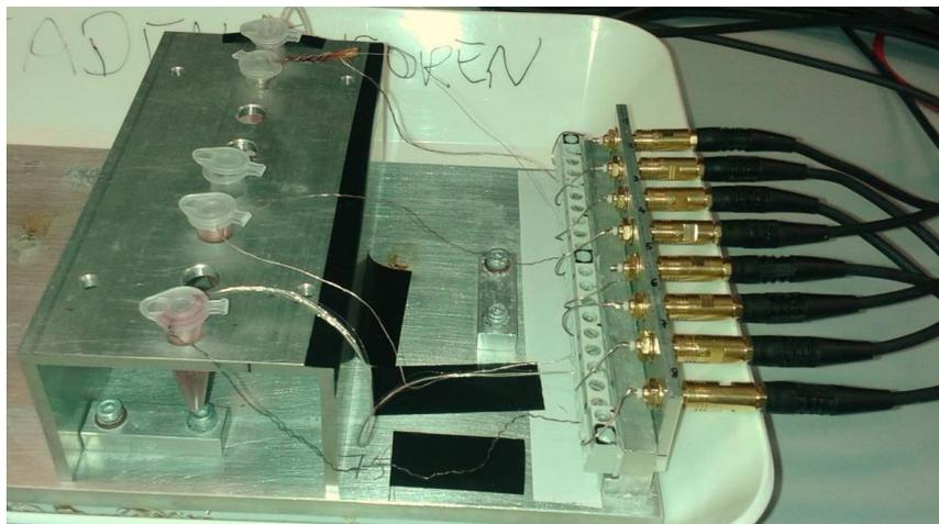
Abbildung 5-24: Halterung für Reaktionsgefäße mit eingebrachten NET-Sensoren im Zellmedium
