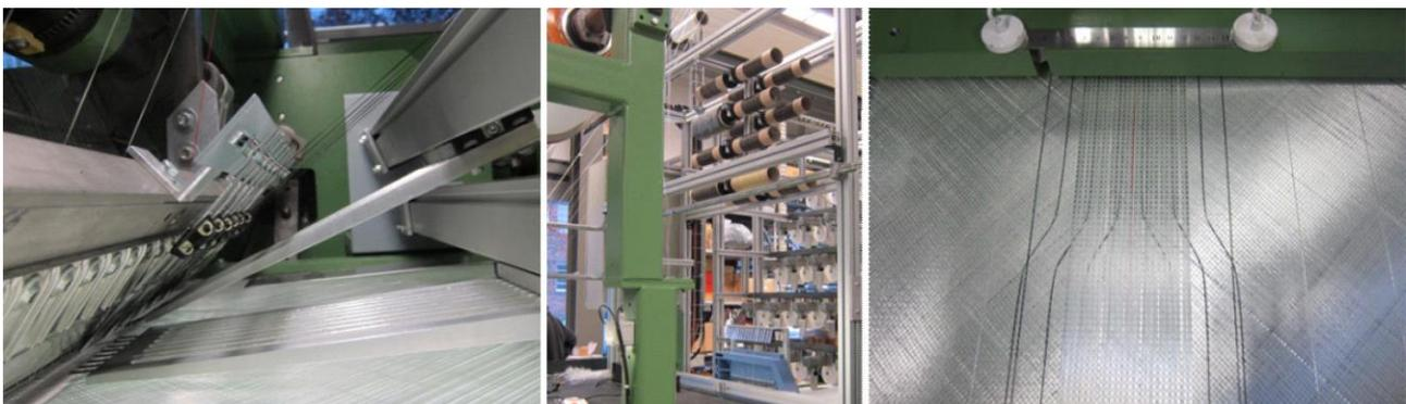
*Abbildung 2-15: Multiaxialwirktechnik für die Herstellung von Sensornetzwerken aus CF zur Erfassung von Dehnungen [Haentzsche et al., 2016]*
