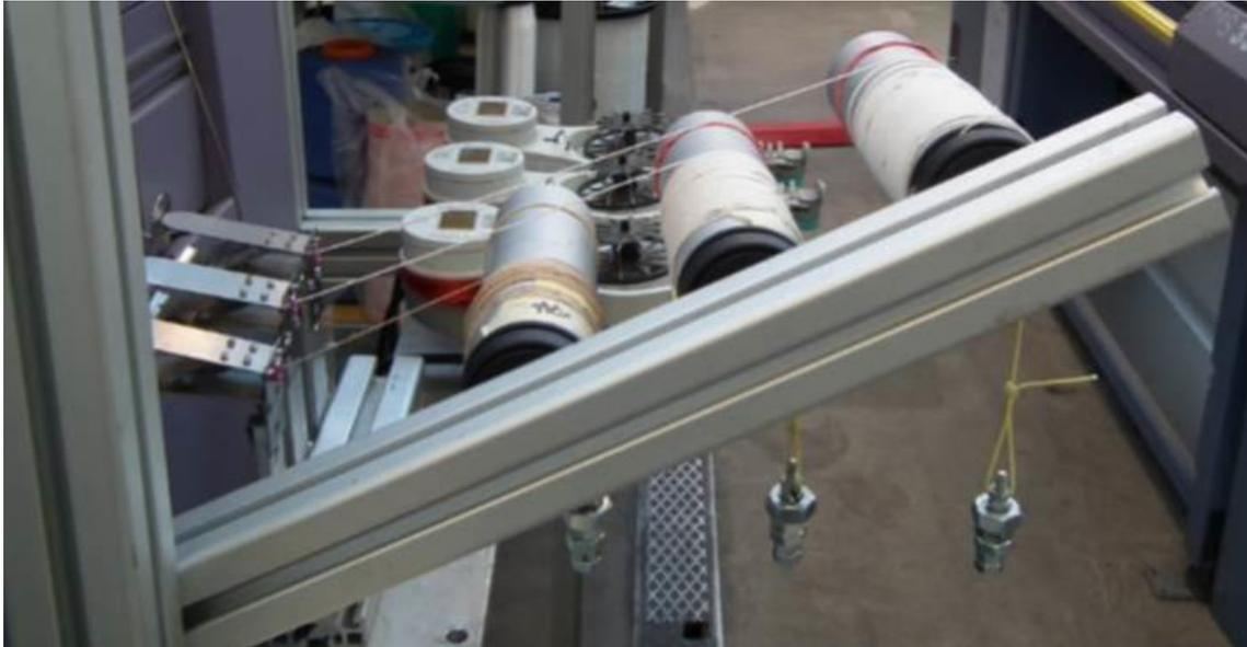
*Abbildung 4-7: Garnhalterung für passive Fadenlieferung*
