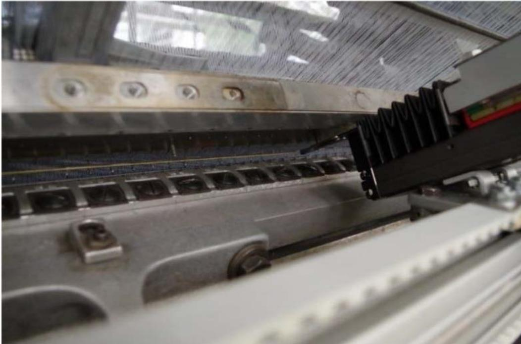
*Abbildung 4-18: Einzelfadenschussvorrichtung an der Raschelmaschine*
