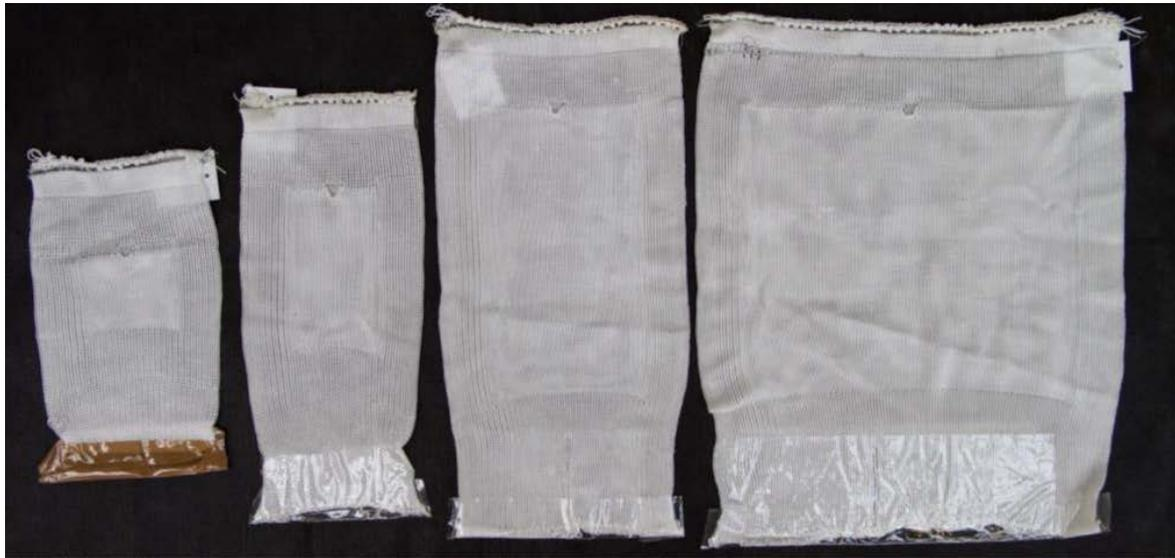
Abbildung 4-11: Muster gestrickter Taschen unterschiedlicher Geometrien ohne Sensornetzwerk
