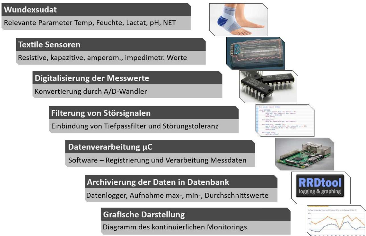
Abbildung 4-20: Prozessschema bzw. Messkette für das Sensorsystem Wundmonitoring
