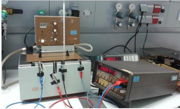
Abbildung 5-1: Versuchsaufbau zur messtechnischen Charakterisierung der Temperatursensoren
