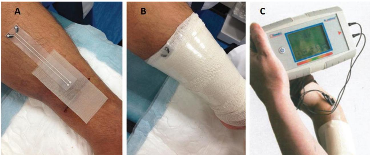
Abbildung 2-5: Feuchtesensor WoundSense© bei der Aufbringung (A), im Verband (B) und während der Messung (C) [Milne et al., 2016]
