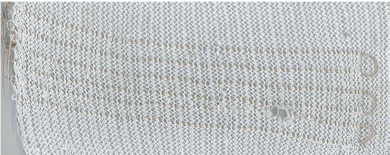
*Abbildung 4-19: Hergestelltes Gewirk mit integrierten textilen Sensoren*
