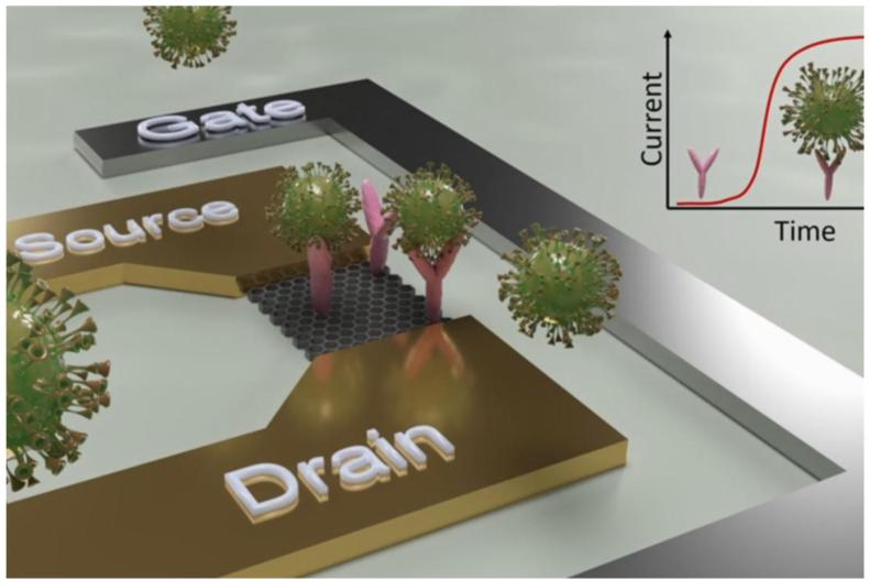
Konstruktionsprinzips eines Sensors zum Direktnachweis von SARS-CoV-2-Viren Schematische Darstellung des Konstruktionsprinzips eines Sensors zum Direktnachweis von SARS-CoV-2-Viren
